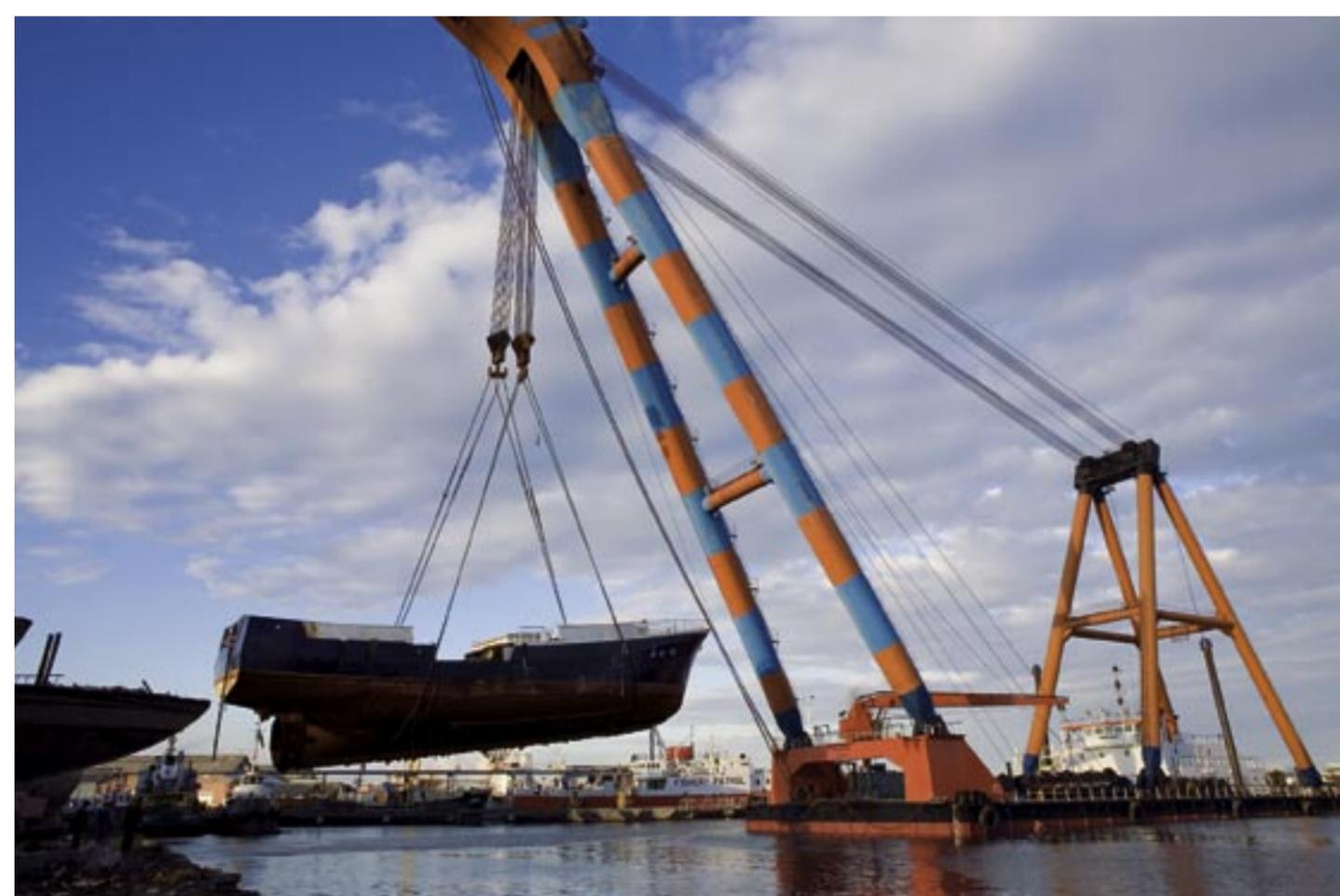
Der Fänger hängt am Haken: Bei Fornæs werden Trawler erst ausgeweidet und dann mit Schneidbrennern so zurechtgestutzt, bis sie nur noch 750 Tonnen auf die Waage bringen. Denn das ist genau die Last, die der Schwimmkran Samson auf den Schrottplatz an Land hieven kann
